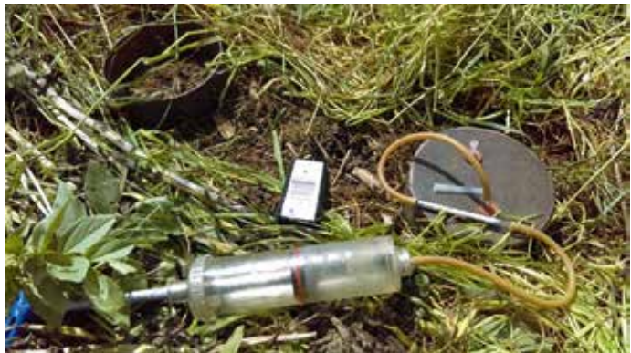
ILLUSTRATION 1: TEST DE LA RESPIRATION DU SOL
