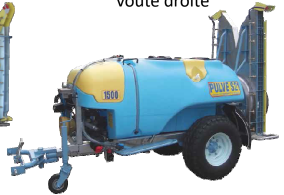
S21 Biturbine Vergers voûte droite
