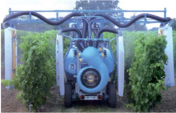
PULVERISATION S21 Tunnel de pulvérisation
