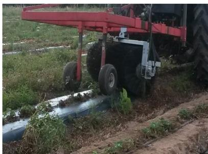
Photo : test balayage film paillage fraise avant dépose avec Invénio en juillet 2018. A permis de réduire de 10% le taux de souillure
